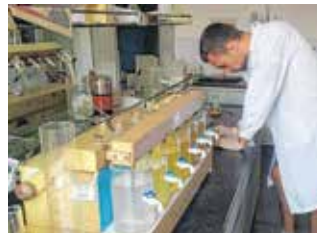
Wissenschaft III: Jan-Hendrik Resing bei einem sogenannten Flokungsversuch im Labor.
